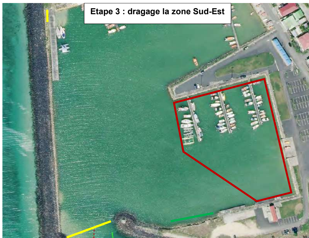
Figure 3-8 : Représentation schématique de l'étape 3 : dragage de la zone Sud-Est
