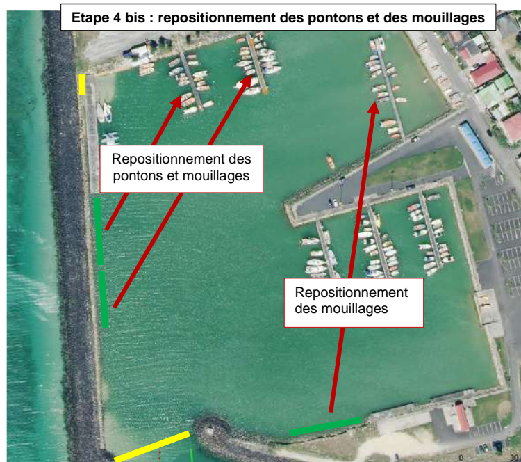
Figure 17 : Représentation schématique de l'étape 4 bis: repositionnement des mouillages des pontons 1, 2 et 3
