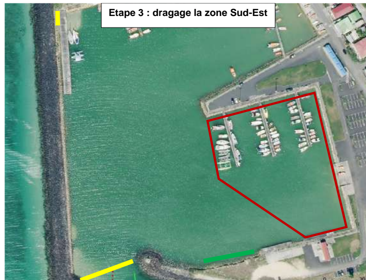
Figure 14 : Représentation schématique de l'étape 3 : dragage de la zone Sud-Est
