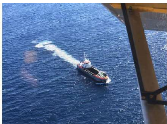
Figure 70 : Illustration d'un clapage en mer réalisé dans le cadre du dragage du port de Sainte-Rose (DE BOER Dec. 2020)
