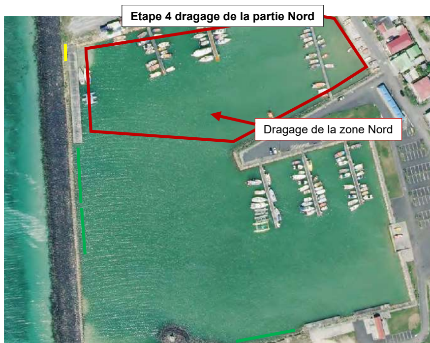
Figure 3-10 : Représentation schématique de l'étape 2 deuxième partie : dragage de la zone Nord
