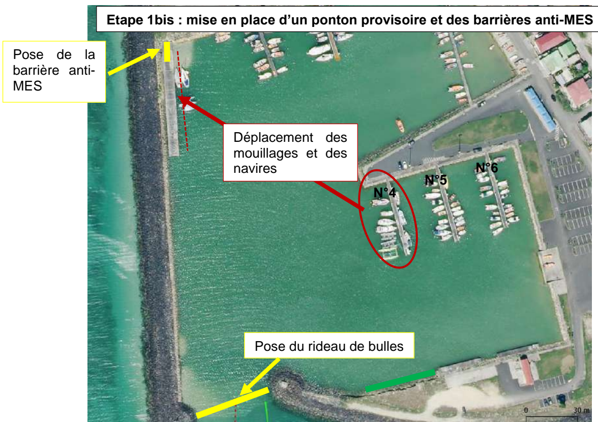
Figure 11 : Localisation du ponton provisoire, du transfert des navires du ponton N°4 et des barrières anti-MES en vue des opérations de dragage du port
