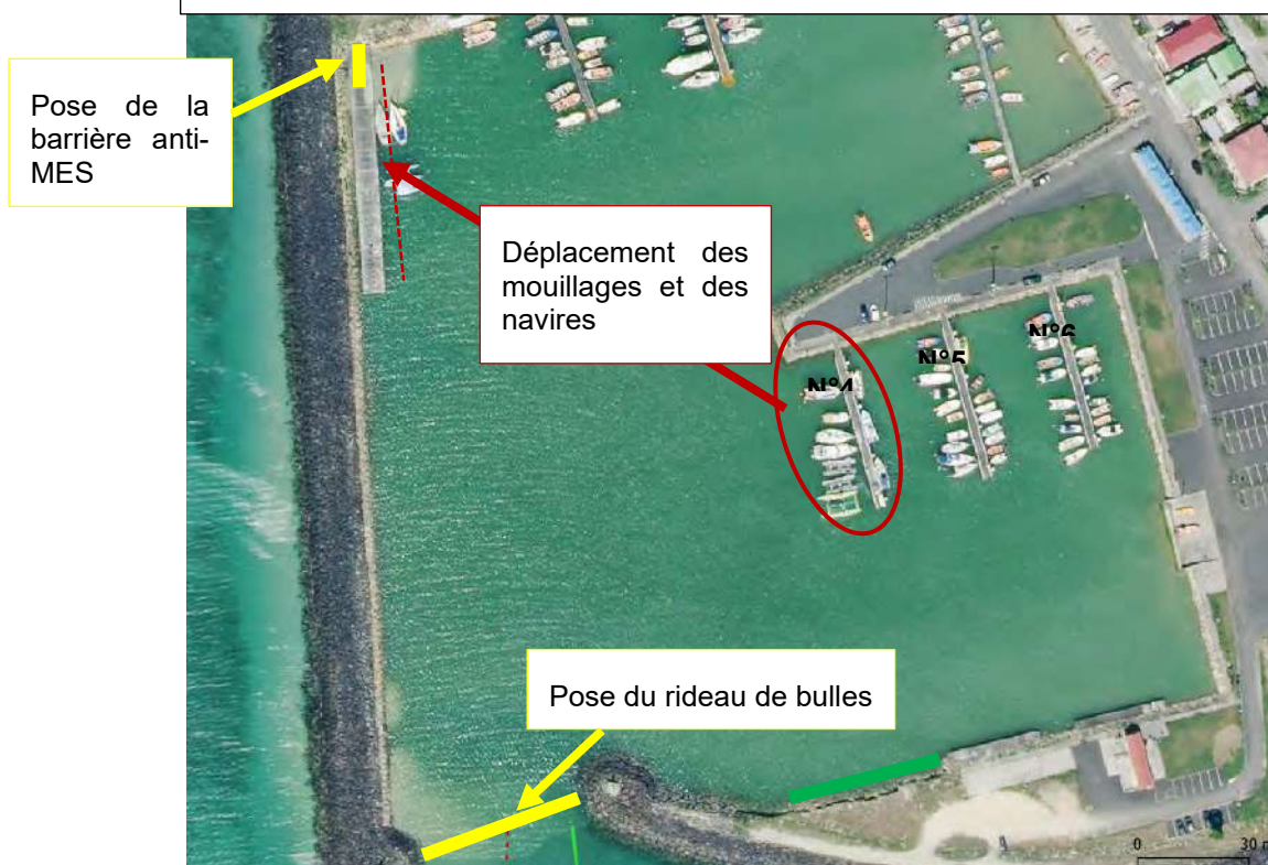
Figure 3-5 : Localisation du ponton provisoire, du transfert des navires du ponton N°4 et des barrières anti-MES en vue des opérations de dragage du port
