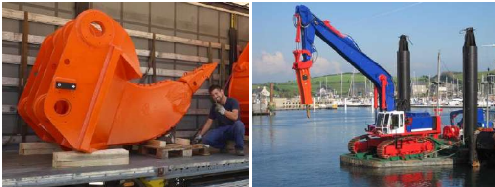
Figure 8 : Illustration (à gauche) d'une dent ripper et (à droite) d'un atelier de déroctage au brise roche hydraulique (source : www.tramaf.fr/ )
