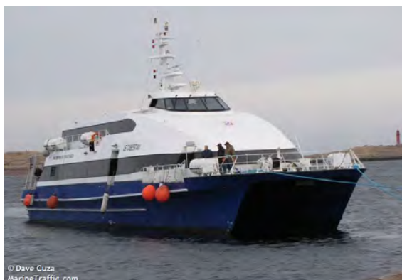
Figure 2-1 : Illustration du type de bateau utilisé pour les liaisons maritime entre Pointe-à-Pitre et Marie-Galante : le SUNNYDAY : longueur hors tout (LOA) = 40 m, largeur = 10 m, tirant d'eau = 1,8 m.
