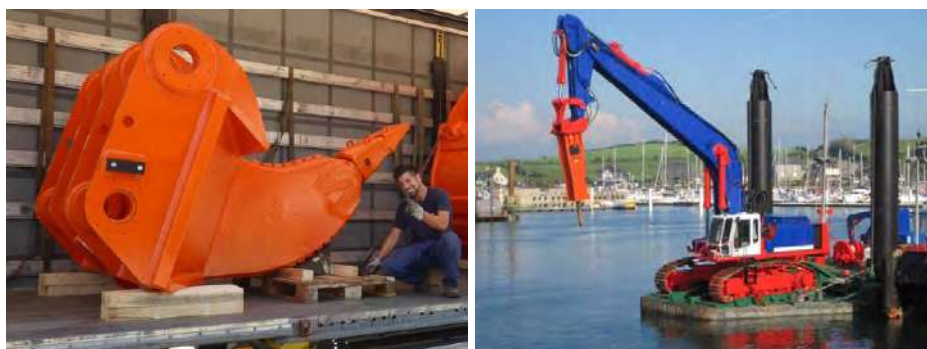
Figure 2-7 : Illustration (à gauche) d'une dent ripper et (à droite) d'un atelier de déroctage au brise roche hydraulique (source : www.tramaf.fr)
